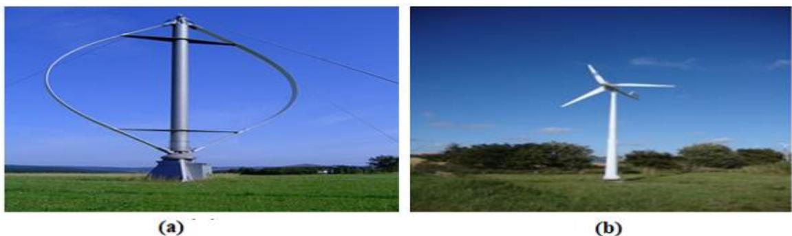
Figure 1.5 –Technologies d'éoliennes : (a)axe vertical (b) axe horizontal [31].
