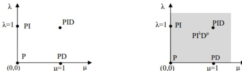
Figure 4.2 – Correcteur PID et  $PI^\lambda D^\mu$
