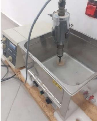
Figure II.25 : Sonificateur utilisé dans la synthèse du NC
