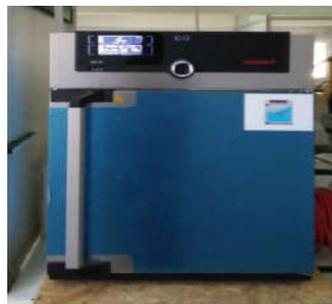
Figure II.24 : Etuve de séchage
