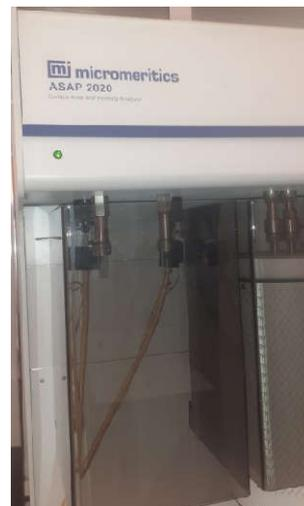
Figure II.9 : Porosimètre micromeritics ASAP 2020.
