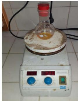
Figure II.23:Agitateur magnétique
