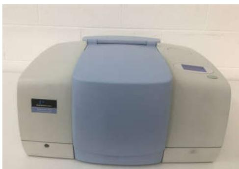
Figure II.8 : Spectromètre infrarouge à transformé de Fourier Perkin Elmer.
