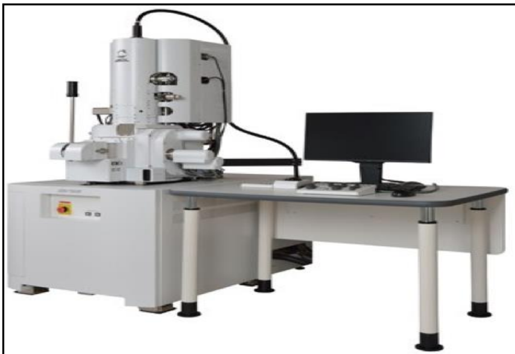
Figure 7 : appareil d'analyse MEB couplé avec microanalyse EDX
