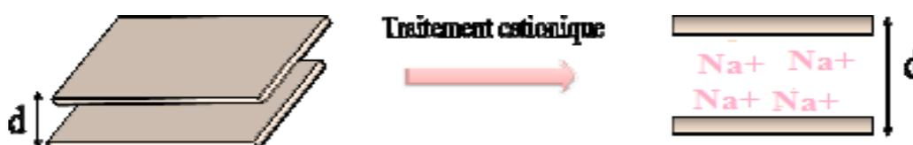
**Figure 01:** Schématisation de la disposition des ions du sodium dans la Montmorillonite.
