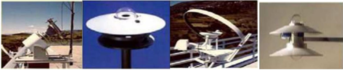
Figure II-1 les appareils de mesure des différents types de rayonnement Direct (Pyrhéliomètre), Diffuse, Réfléchi, Globale (Pyranomètre) [6].
