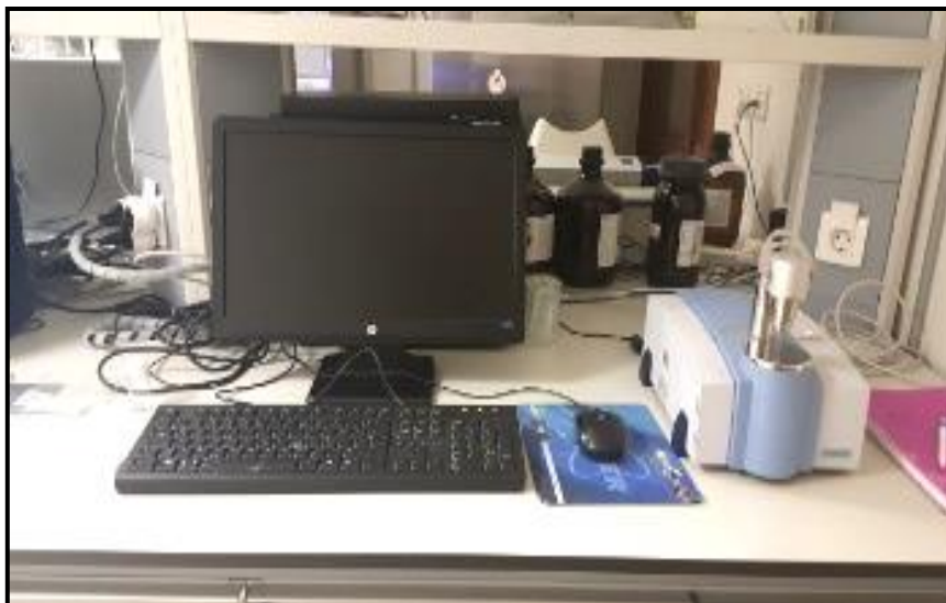
Figure II-10. Infrarouge à Transformée de Fourier de marque Perkin Elmer type 1720-x
