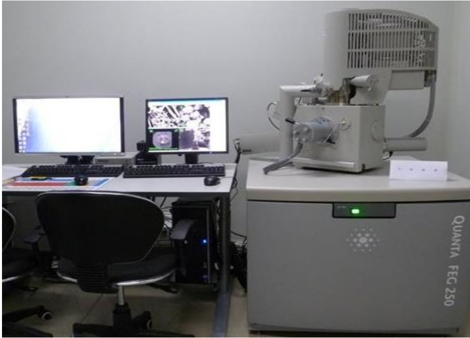
Figure II-11. MEB de la marque Quanta FEG 250
