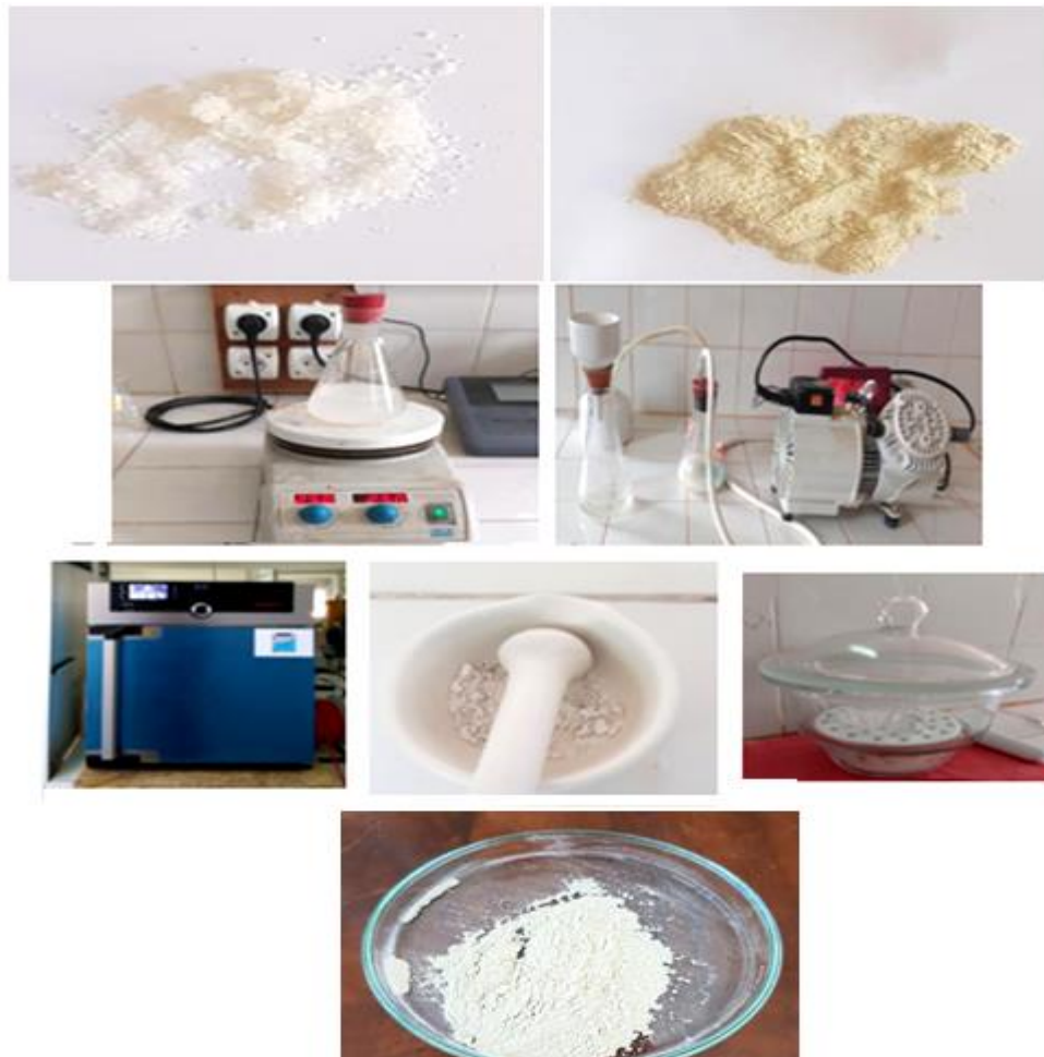
Figure II- 5. Protocole de la préparation du composite Alumine/Argile-H +
