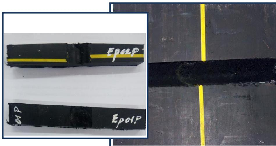
**Figure III.18 : Usinage des éprouvettes**
