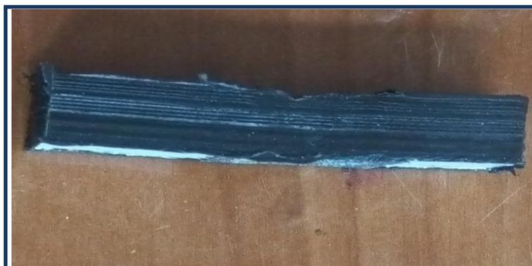
Figure III.27: *Éprouvette pour l'essai de dureté (avant polissage)*
