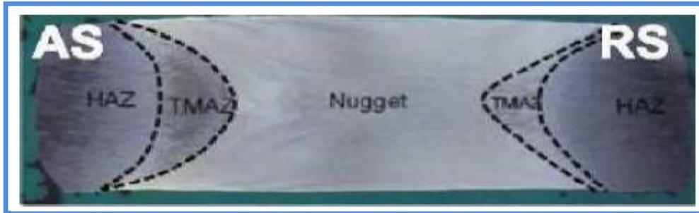
**Figure II. 15 : Symétrie du cordon FSW de 9mm d'épaisseur de nuance AA2195-T87 obtenu par un outil à double épaulement (bobbin tool ) [64].**
