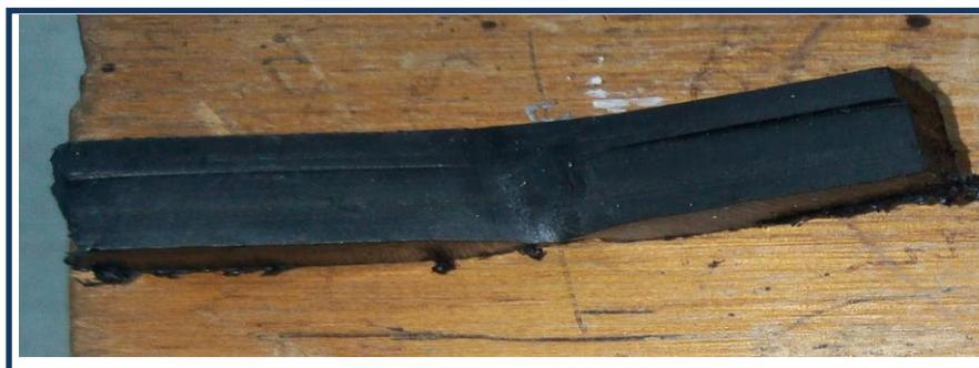
Figure III.36 : Éprouvette non rompue (essai de Charpy).
