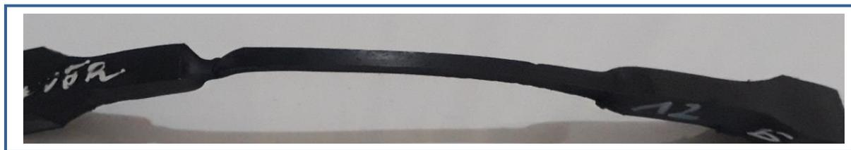
Figure III.31 : Image d'une éprouvette soudée avec BT-FSW après essai de traction
