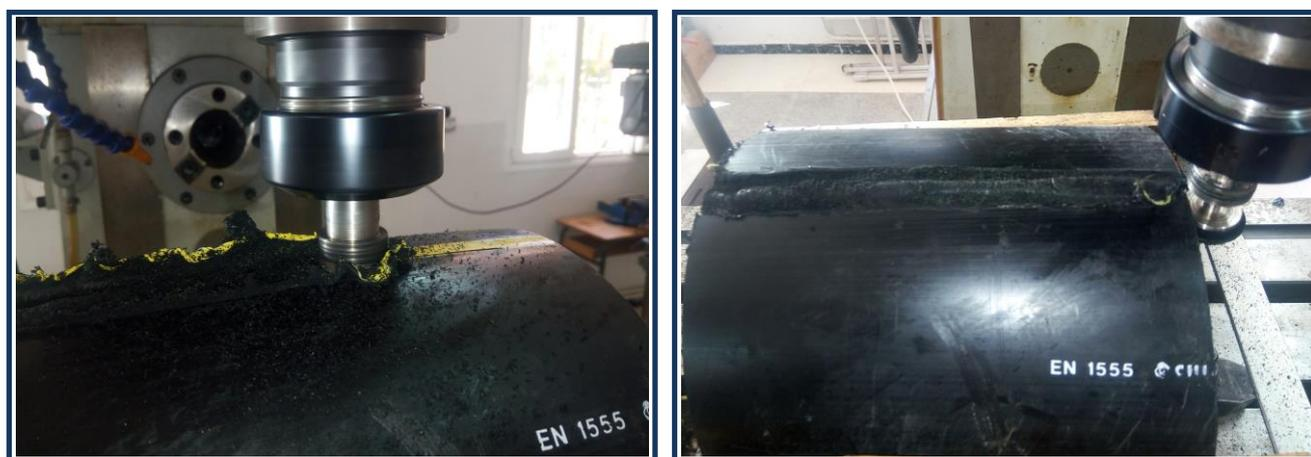
**Figure III. 14:** Soudage BT-FSW d'une coupe longitudinale de tube PEHD 100 Ø125.
