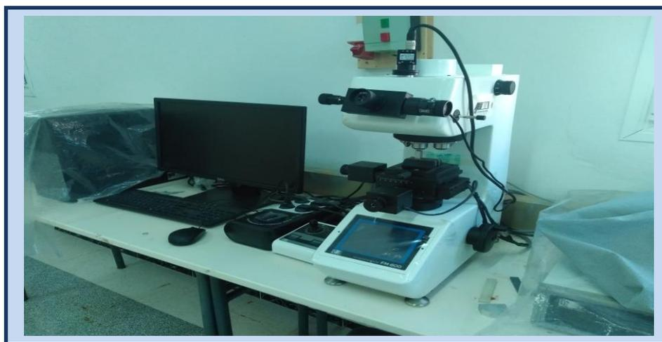
Figure III.26: *Dispositif pour l'essai de micro-dureté piloté par ordinateur.*
