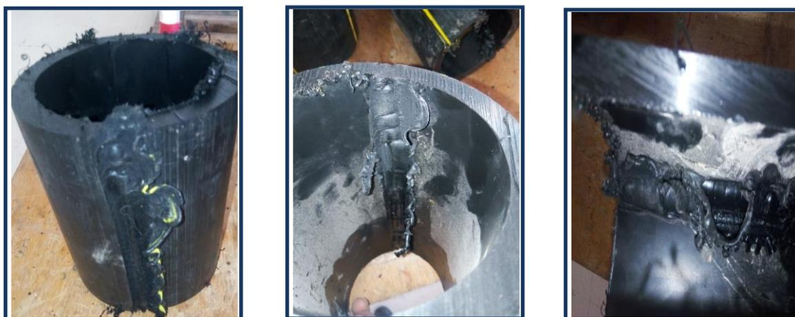
Figure III. 15: les principaux défauts de soudage observés.
