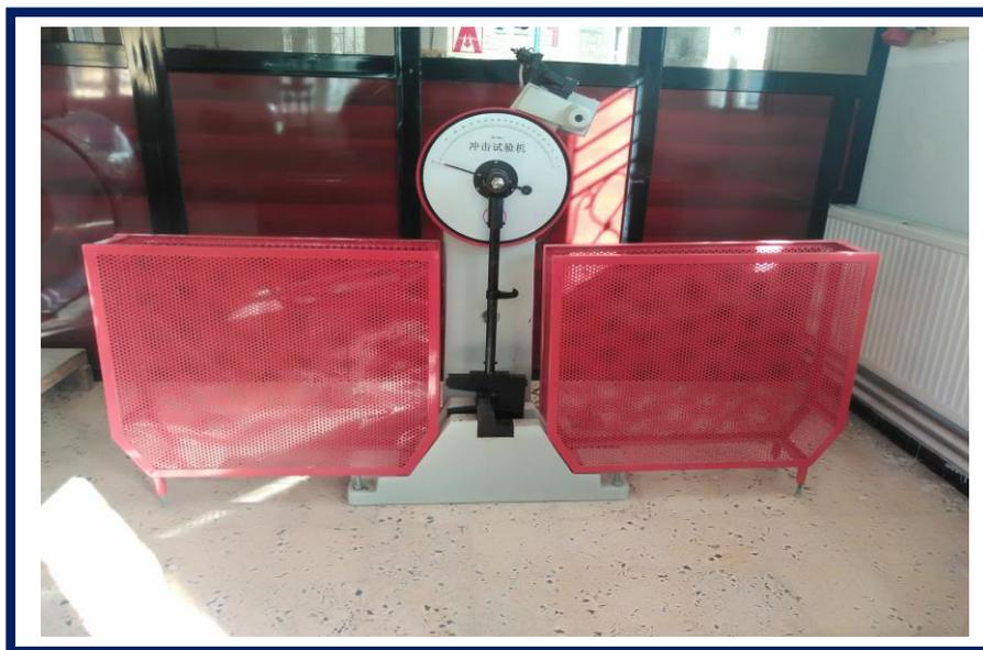
**Figure III.24 : Appareil d'essai de choc (Charpy).**
