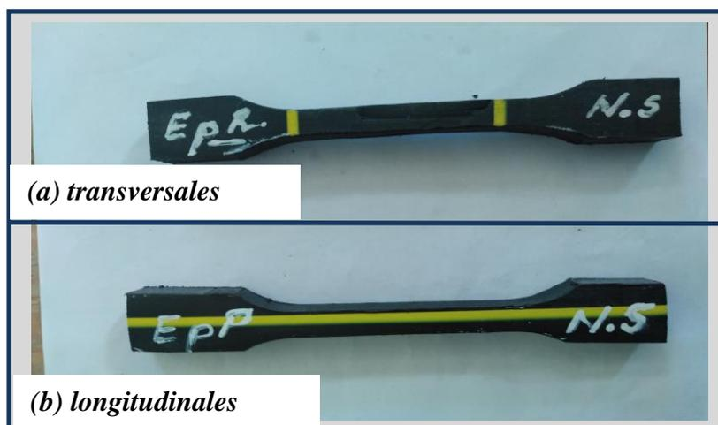
**Figure III.2:** *Éprouvettes PEHD pour les essais de traction uni-axiale : (a) éprouvette transversales, (b) longitudinales*
