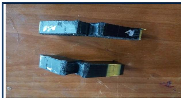
Figure III.37 : Éprouvettes rompue (soudées).
