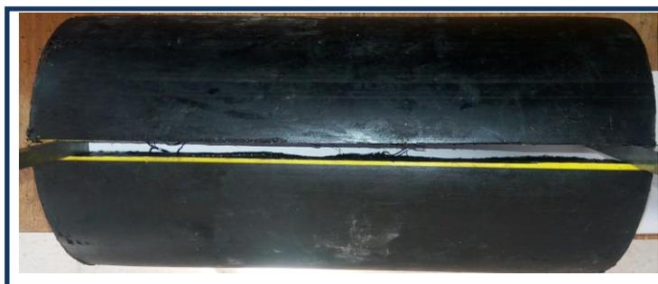
**Figure III. 13:** Image d'une fissure longitudinale (Tube PEHD 100 Ø125 GAZ).
