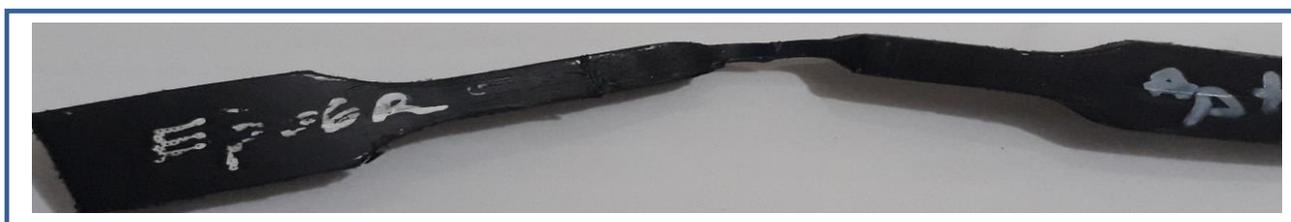
**Figure III.34 : Rupture d'éprouvette soudée par C-FSW (au niveau du joint de soudure).**
