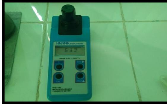
Photo 23: Turbidimètre (Source : ONA ,2017).
