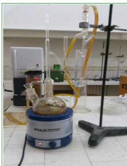
Figure 18 : Photo de montage d'hydrodistillation type Clevenger (cliché personnel)
