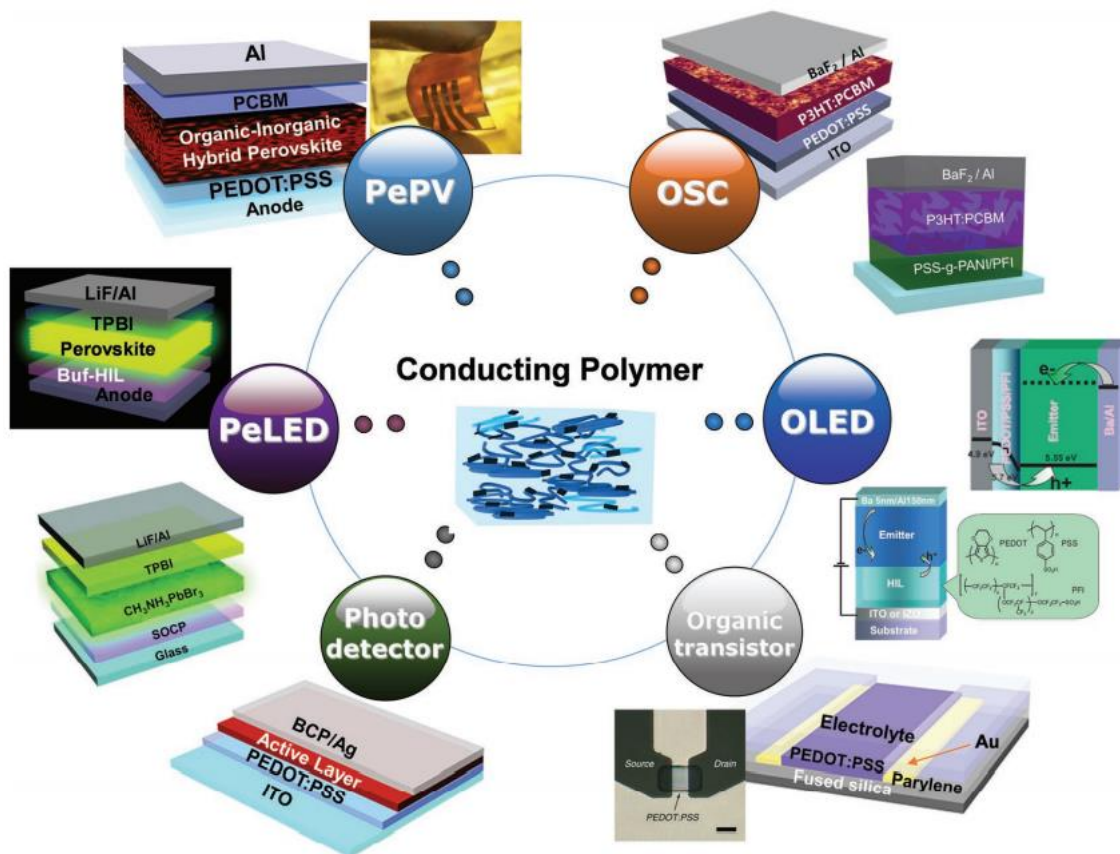
Figure I.14. Applications des polymères conducteurs à l'électronique [49].
