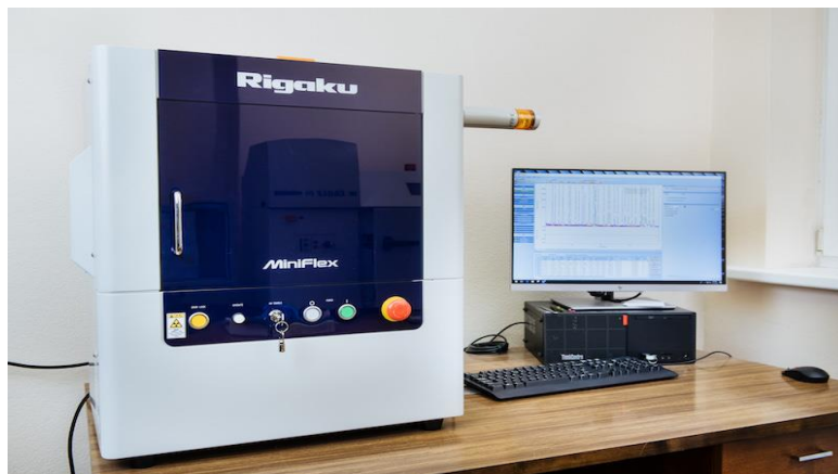
Figure II.7. Illustration schématique de l'équipement d'un diffractomètre à rayons X [12].
