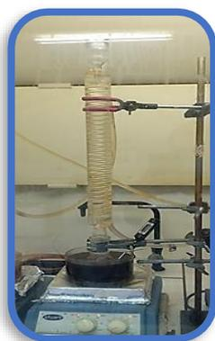
**Figure VI. 6.** Photo du montage expérimental de la synthèse du  $\alpha,\omega$ - bisinsaturé PCL macromonomère.
