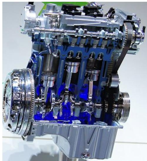
**Figure I.1** : Moteur réduit à 3 cylindres [1]
