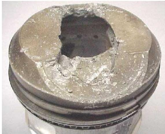
Figure I.25 Piston détruit par une combustion détonante [11].
