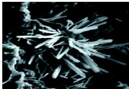
**Figure 3.28.** Ettringite primaire non expansive dans la pâte de ciment, vue au microscope électronique à balayage
