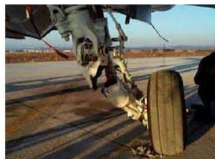
**Figure 4.55.** Fissuration au niveau du mécanisme d'atterrissage d'un avion.
