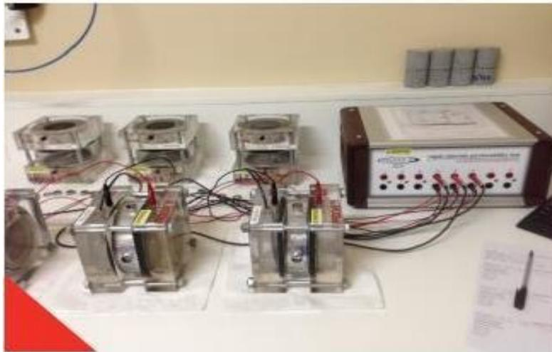
**Figure 4.14.** *Équipement pour essai accélérer de la migration des ions chlorures.*
