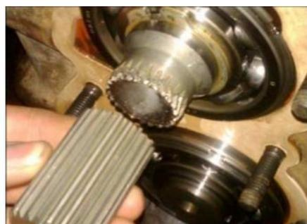
**Figure 4.54.** Rupture d'un arbre cannelé.
