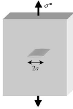
**Figure 4.47.** Fissure traversant de longueur  $2a$  dans une plaque infinie. [89]
