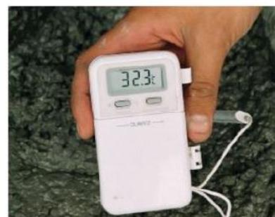
**Figure 3.45.** *Accroissement de la température du béton en fonction de celle des constituants.* [73]
