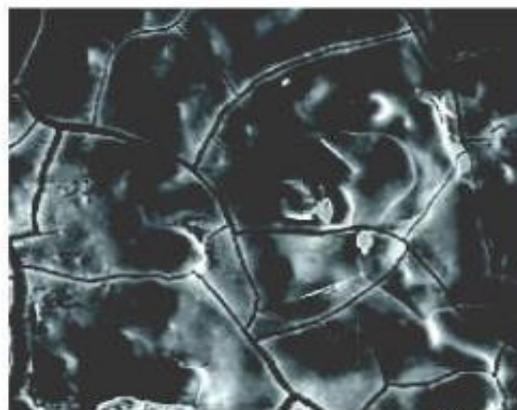
**Figure 3.14** Gel d'alcali-réaction (agrandissement x 500)
