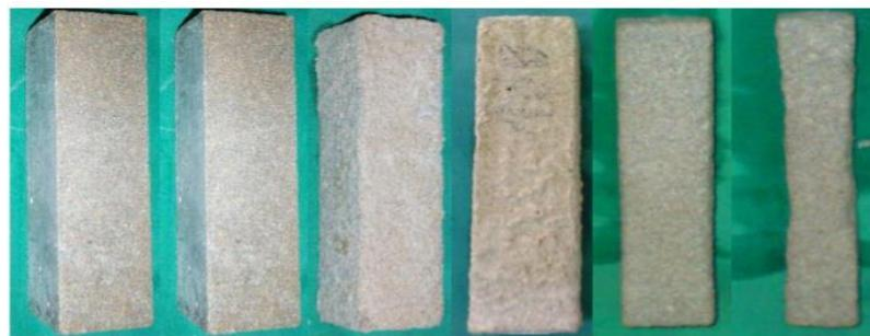
**Figure 3.17.** Evolutions de dégradation des éprouvettes en mortier de ciment dans des milieux acides à différentes concentration. [38]
