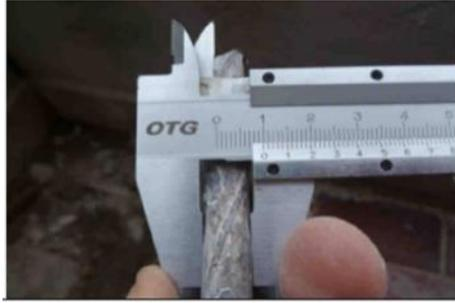
**Figure 4.9.** Prélèvement d'aciers.
