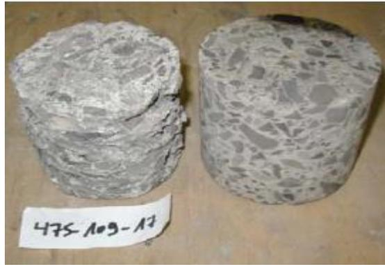
**Figure 3.16.** Carotte de béton (320 kg/m<sup>3</sup> de ciment CEM I 42,5 R, E/C 0,5) soumise pendant 27 jours à des cycles d'attaque à l'acide acétique (pH 4,5). A titre de comparaison, à droite, une carotte de béton identique, non soumise aux essais
