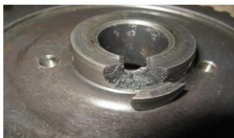
**Figure 4.50.** Détachement d'une partie métallique.
