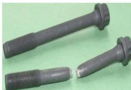
**Figure 4.53.** Rupture d'un tirant.
