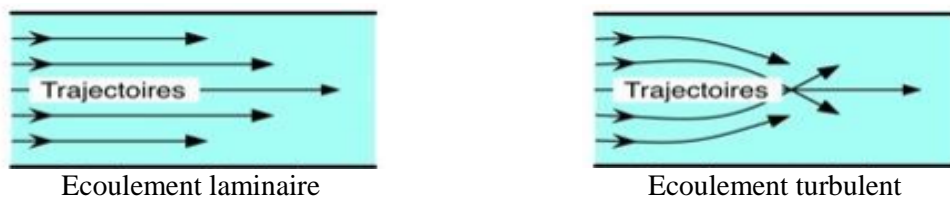
Figure 6.21 : Ecoulement laminaire ou turbulent.
