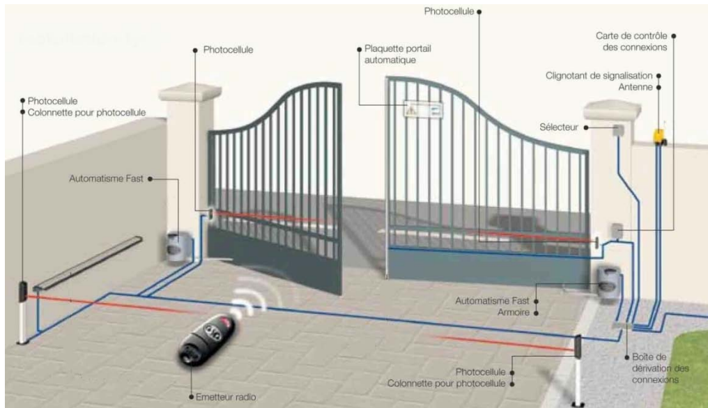
Figure 1.4 : Schéma d'un portail automatique.
