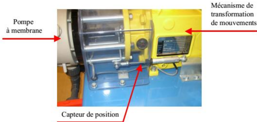
Figure 7.10 : Montage de bicompression avec un capteurs LVDT.
