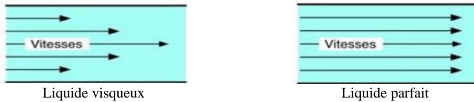
Figure 6.20 : Influence de la viscosité sur la vitesse du fluide.
