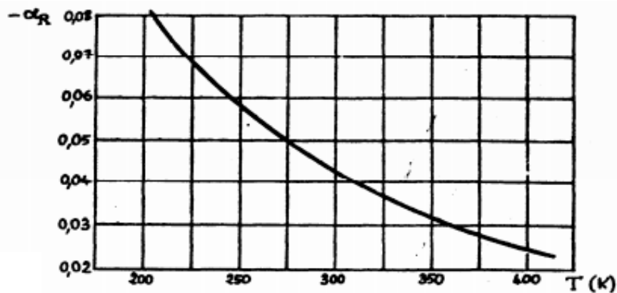
Figure 4.12: Relation sensibilité thermique-température .
