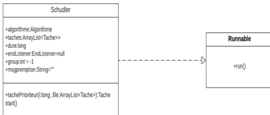
**Figure 5.5:** Relations de réalisation de l'interface *Runnable*
