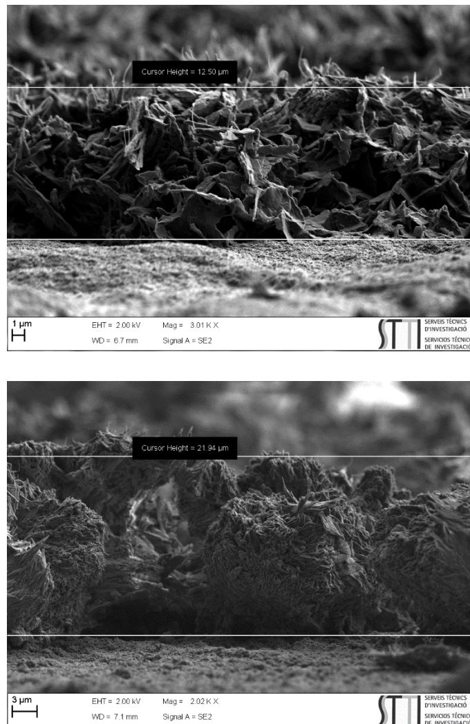
Figure IV.10 : Micrographies FESEM de la section transversale des matériaux composites CV/TiC/PolyPPD et CV/TiC/TiC+TiO 2 @PolyPPD.
