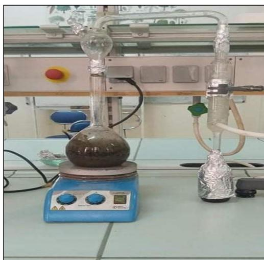
**Figure 14 :** Montage d'hydrodistillation
