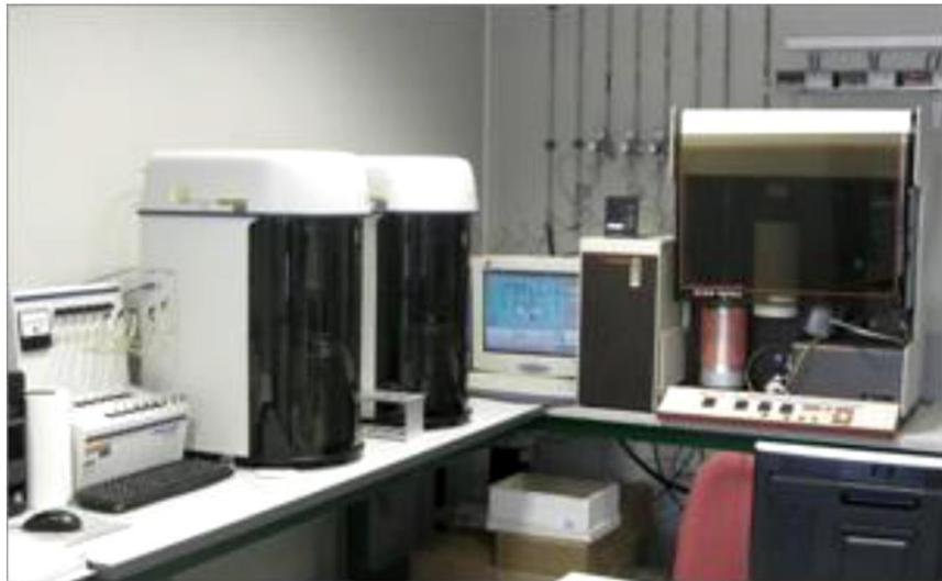
**Figure II.8.** Instrument de mesure de la surface spécifique par B.E.T.
