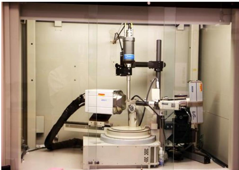
**Figure II.2** L'équipement Bruker CCD-Apex.
