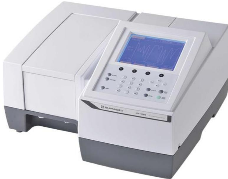
**Figure 49:** Appareil de spectrophotomètre UV-Visible
