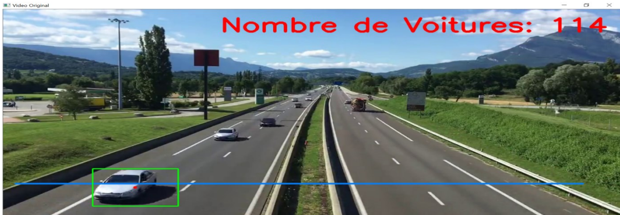
Figure IV.8 Comptage des Véhicules 1er scenario (Trafic Moyen)
