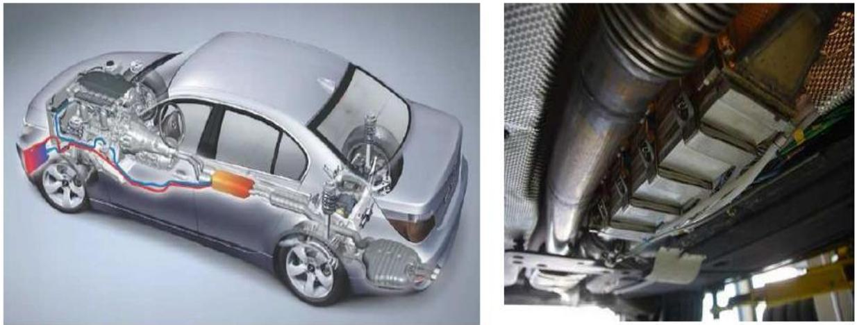
**Figure I.1.** Conception d'un générateur thermoélectrique produisant de l'électricité de la chaleur perdue au niveau du pot d'échappement d'un véhicule (source BMW).
