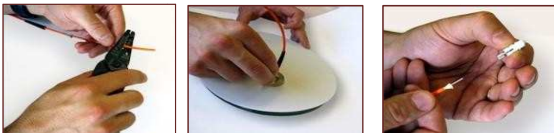
Figure 1.21 : les étapes de montage démontable (connecteurs).
