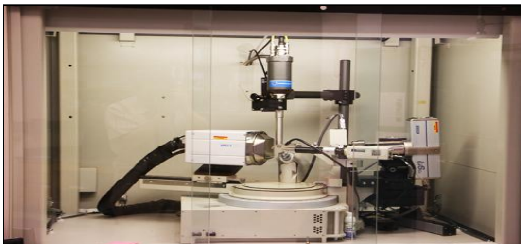
Figure 2.7. Diffractomètre de rayons X Bruker Apex CCD .
