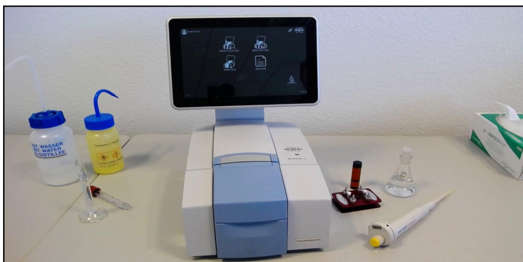
Figure 2.5. Spectromètre infrarouge à transformée de Fourier (FT-IR) Bruker Alpha.
