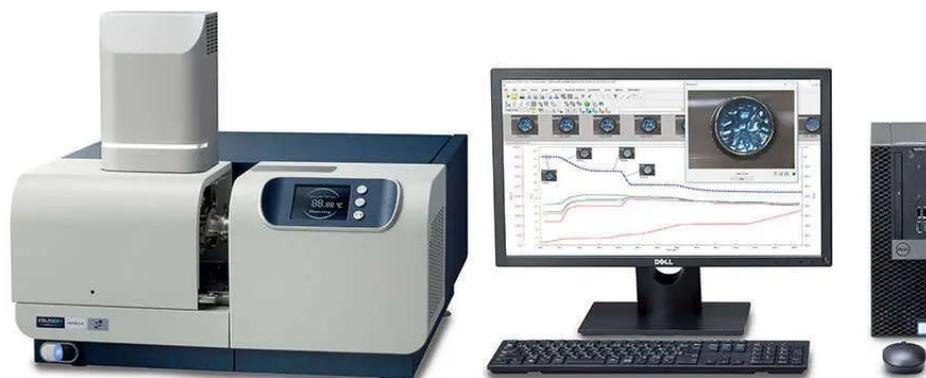
Figure.II.16 thermogravimétrie (TGA) Hitachi STA7200.
