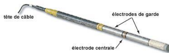
Figure 27.IV Le latérolog 3 utilisé à l'Institut de Géophysique de l'Université de Lausanne.
