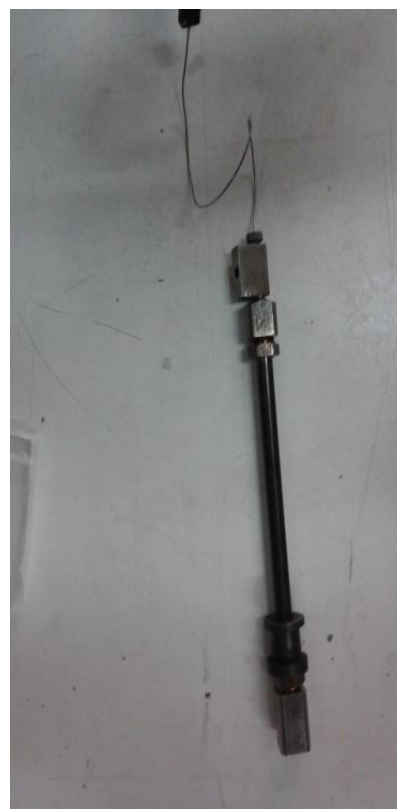
Figure II-3: Schéma du réacteur utilisé pour les essais de la réaction ESR.
