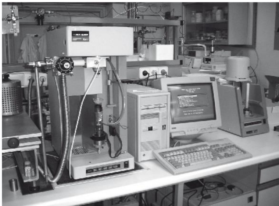
Figure II-13: L'équipement de thermobalance à flux vertical (Perkin Elmer TA-7) avec interface pour connexion à un spectromètre de masse.
