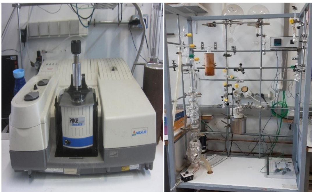
Figure II-14: L'équipement de l'infrarouge et le montage de l'adsorption avec l'acétonitrile.
