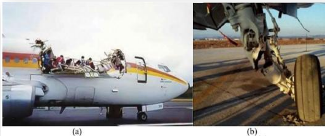
Figure II .2: Accidents aériens liés à la fatigue: (a) Défaillance du fuselage (b) Défaillance du train d'atterrissage [23].
