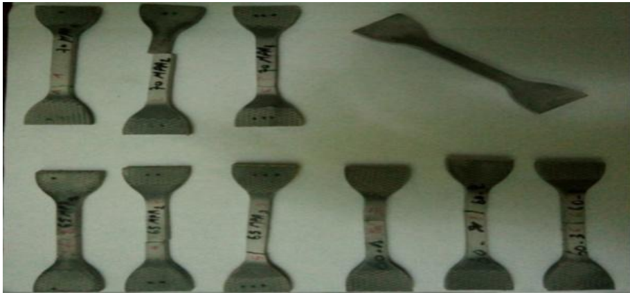
Figure IV.5 : Eprouvettes fracturée par fatigue.
