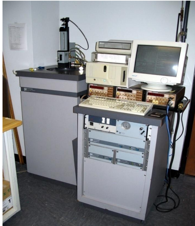
Figure III-18 : SQUID utilisé pour les mesures magnétiques macroscopiques.
