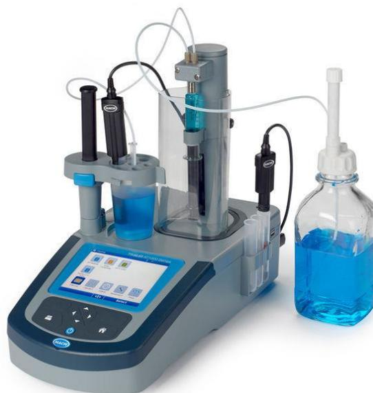
**Figure III.b:** Conductimètre (Titralab AT 1000 series)
