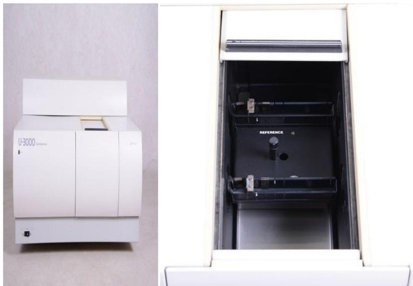
*Figure II.8 Spectrophotomètre Hitachi-U 3000*
