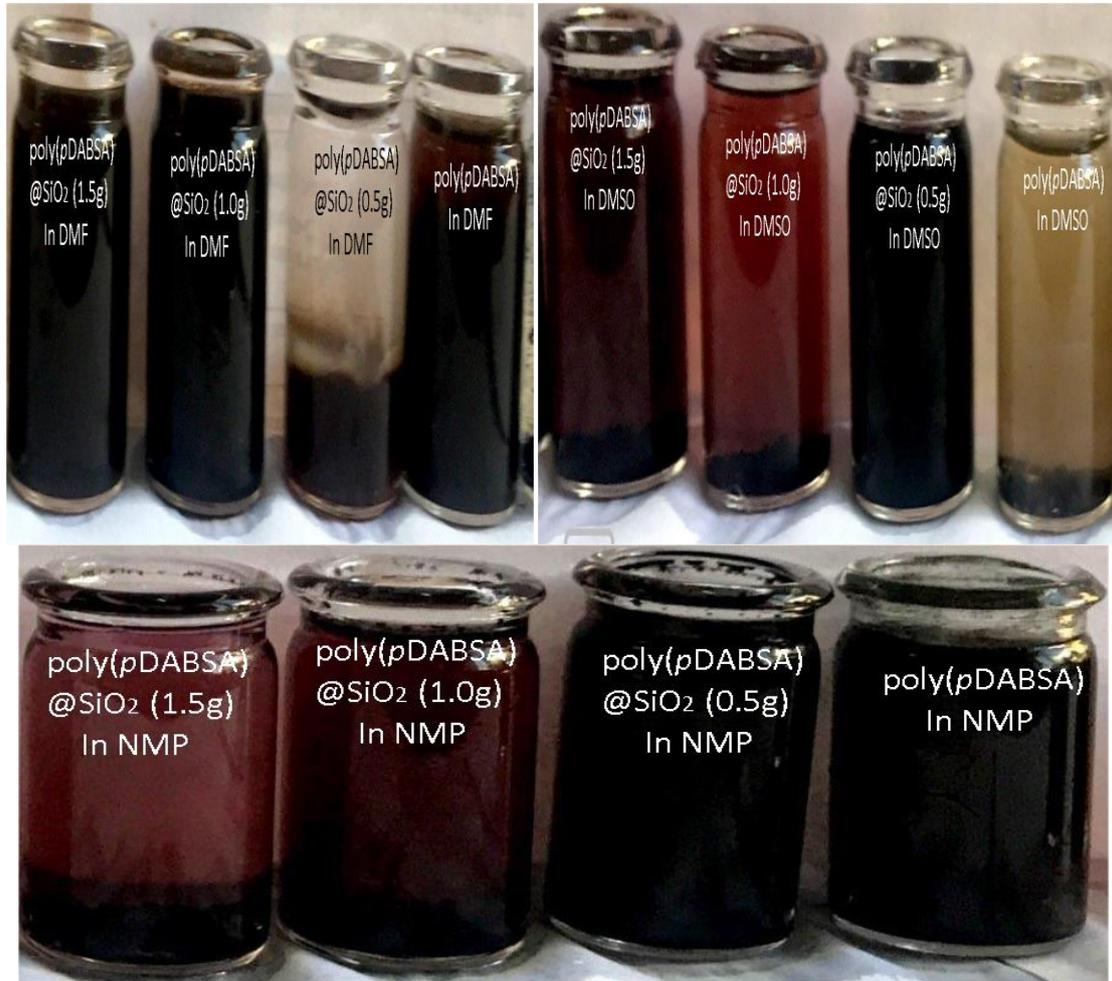
**Figure IV.7** – La solubilité des nanocomposites poly(oASA)/ SiO<sub>2</sub> avec différentes quantités de SiO<sub>2</sub> : (0.5g ,1g et 1.5g ) dans DMF , DMSO et NMP
