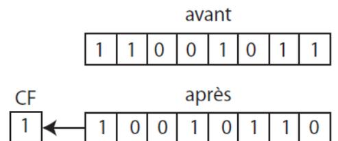
→ entrée d'un 0 à la place du bit de poids faible ; le bit sortant passe à travers l'indicateur de retenue CF.
