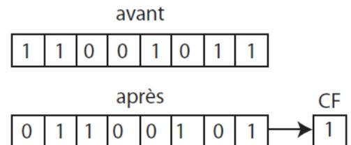
→ entrée d'un 0 à la place du bit de poids fort ; le bit sortant passe à travers l'indicateur de retenue CF.
