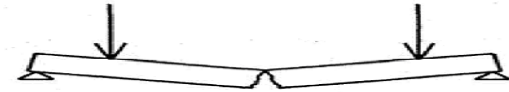
Figure 2.21. Diagramme d'une poutre en béton sans armature.
