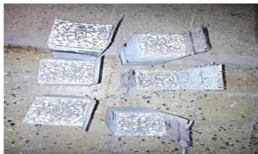
Figure 2.25. Mode de rupture des poutres fléchies (décollement du composite). [OUL 16]
