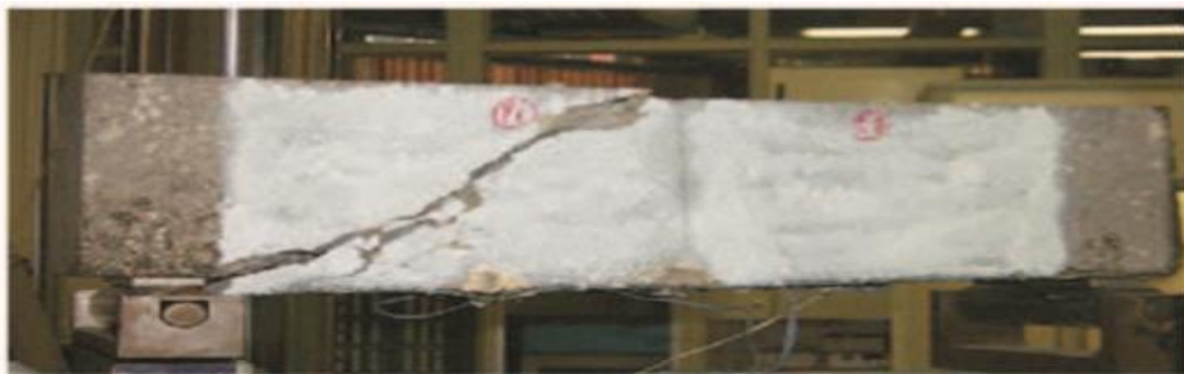
Figure 1.30. Fissure causée par l'effort tranchant près de l'extrémité du tissu.[BENN 13]
