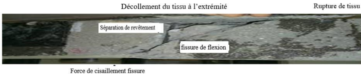
Figure.2.26. Modes de rupture des poutres renforcées de matériaux composites FRP.
