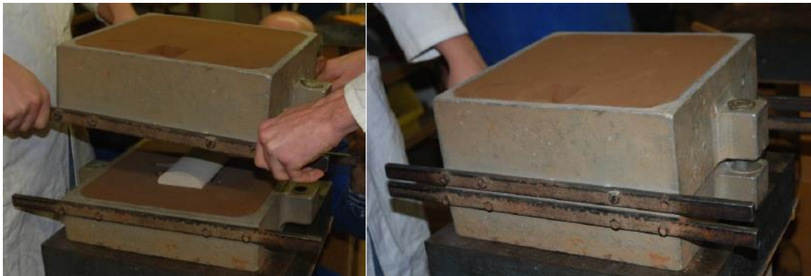
Figure 2.16 : Assemblage des deux châssis.
