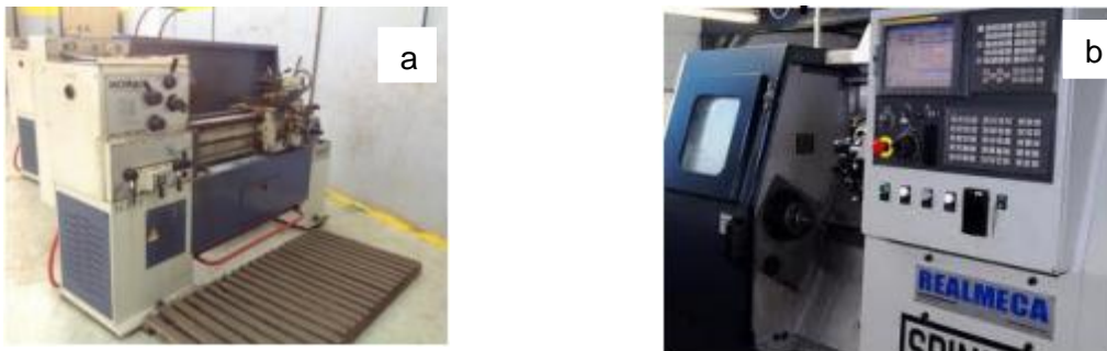
Figure 2.3 : a) Tour parallèle. b) Tour à commande numérique.
