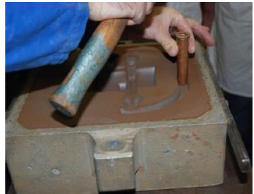
Figure 2.13 : Prolongation du trou de coulée.
