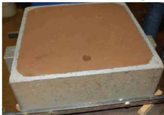
Figure 2.14 : Finition du trou de coulée.
