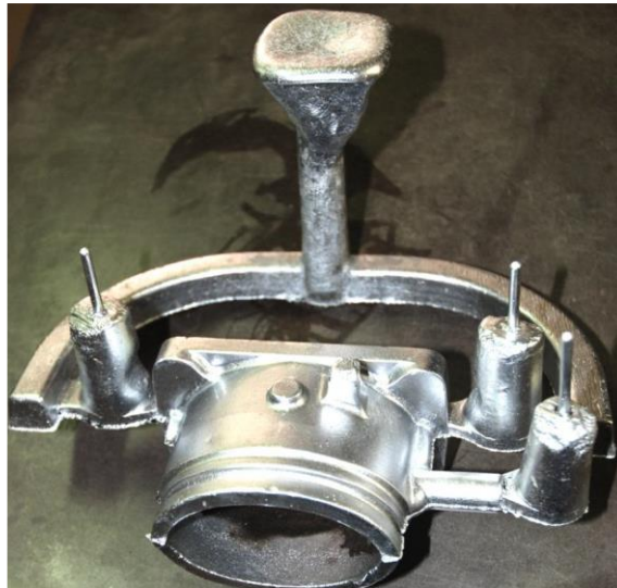
Figure 2.21 : La pièce brute de démoulage.
