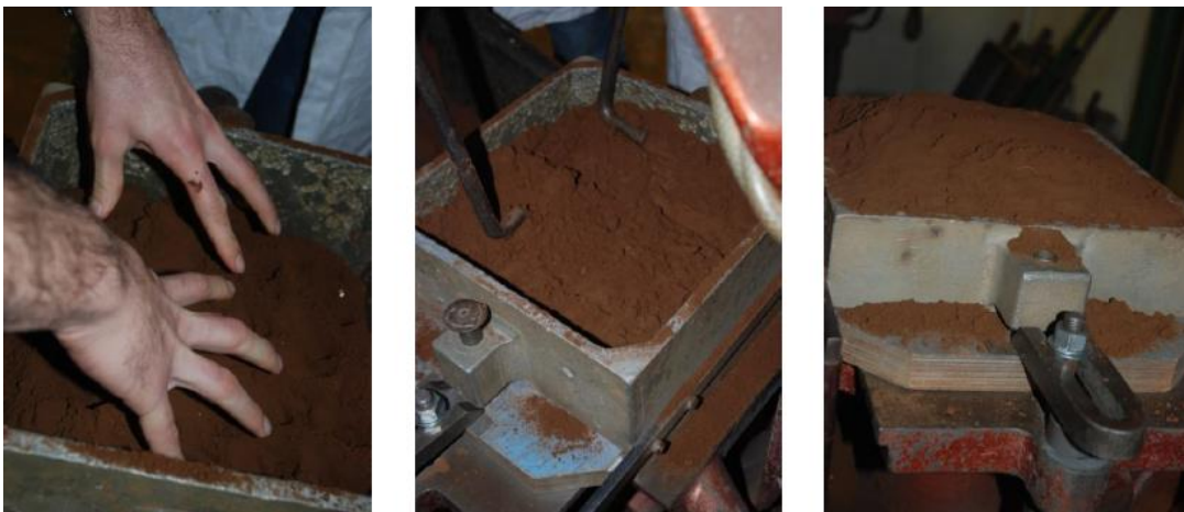
Figure 2.7 : Remplissage du châssis avec le sable à vert.
