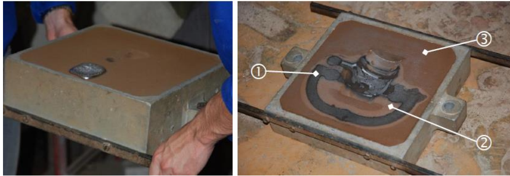
Figure 2.18 : Séparation des deux châssis. Les différentes couleurs du sable après extraction de la pièce :1) partie brûlée, 2) partie chauffée jusqu'à environ 100°C (évaporation de l'eau), 3) partie non affectée thermiquement (importante isolation du moule en sable, le châssis reste à température ambiante).
