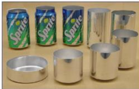
Figure 3.19 : exemple de pièce emboutie (canette de boisson).
