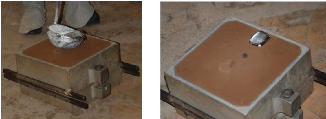
Figure 2.17 : Coulée et remplissage du moule.
