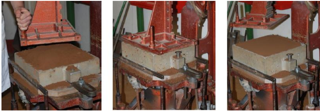
Figure 2.8 : Tassement mécanique du sable à vert dans le châssis.
