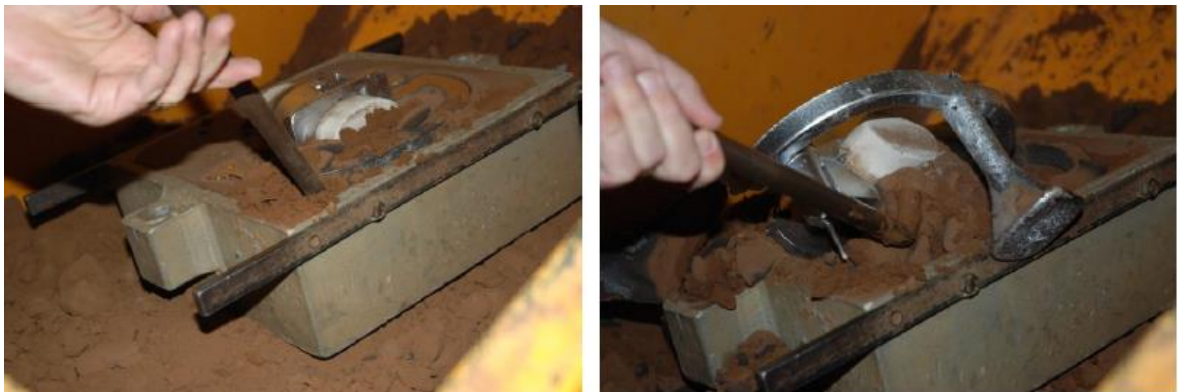
Figure 2.20 : Destruction du moule pour extraire la pièce brut de moulage et son noyau inclus.
