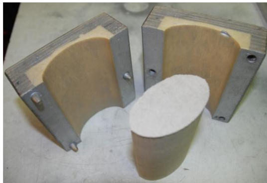
Figure 2.4 : Le noyau sorti de sa boîte.
