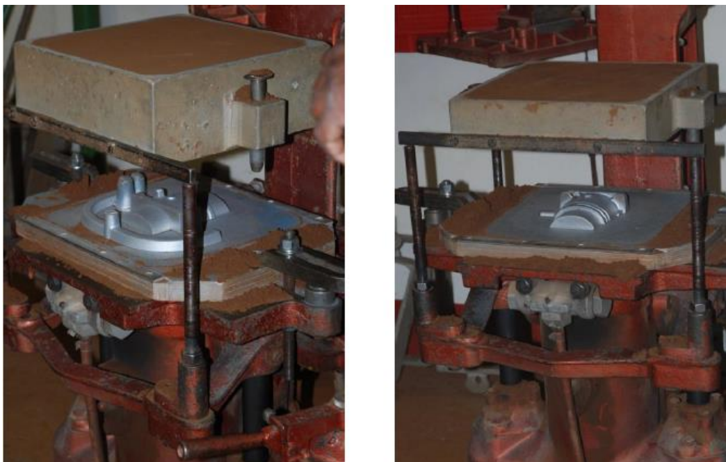
Figure 2.10 : Montée du châssis, libération des plaques modèle.
