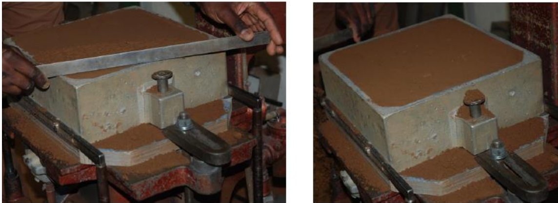
Figure 2.9 : Arasement du sable.
