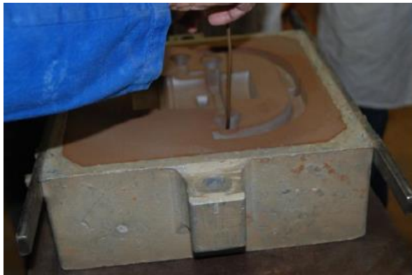
Figure 2.12 : Réalisation des événements à l'aiguille.
