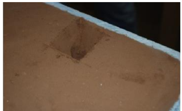
Figure 2.14 : Finition du trou de coulée.
