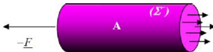
Efforts intérieurs appliqués par la partie B sur la partie A.
