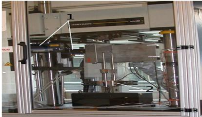
Fig. IV.7. Dispositif de traction grande vitesse (TGV) du CdM. 1) Cellules laser à effet Doppler pour la mesure de déformation 2) Dispositif de mors enserrant l'éprouvette "à la volée" lorsque la vitesse de déplacement désirée est atteinte. La vitesse de déplacement maximale de la traverse est de 25 m/s, la charge maximale de 80 KN, l'énergie d'environ 6 kJ ; il est possible de réaliser des essais en température, entre -135 et +250 °C.
