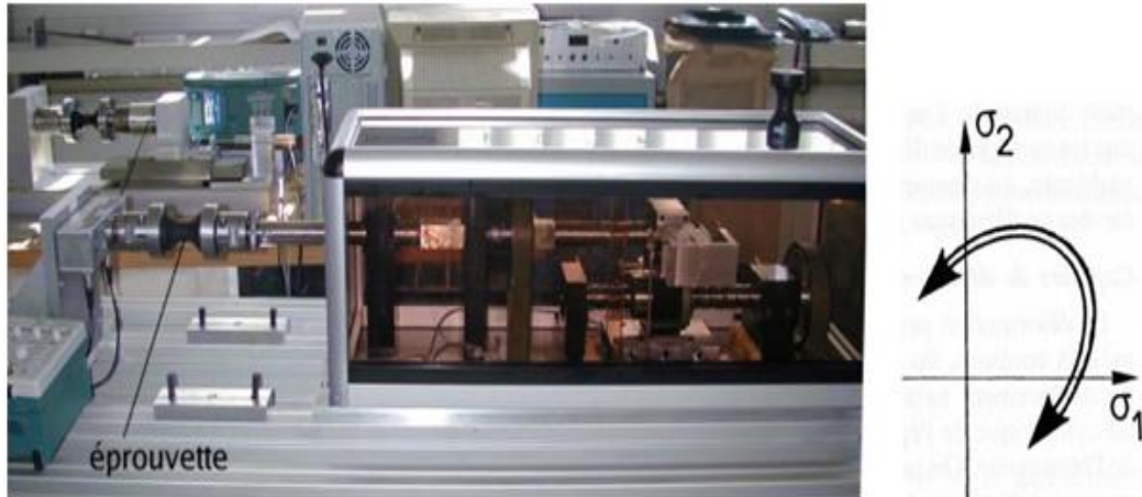
Fig. IV.12. Photo de gauche : dispositif de traction-torsion du Centre des Matériaux, image de droite : chemin mécanique pouvant être appliqué sur une éprouvette lors d'essais de traction torsion.
