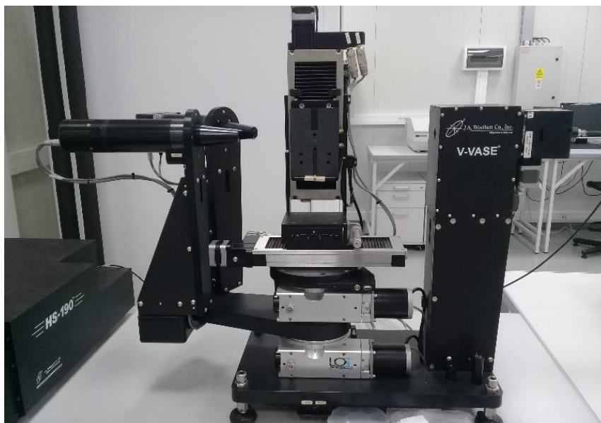
Figure 30: Appareil d'analyse ellipsomètre en mode UV-vis
