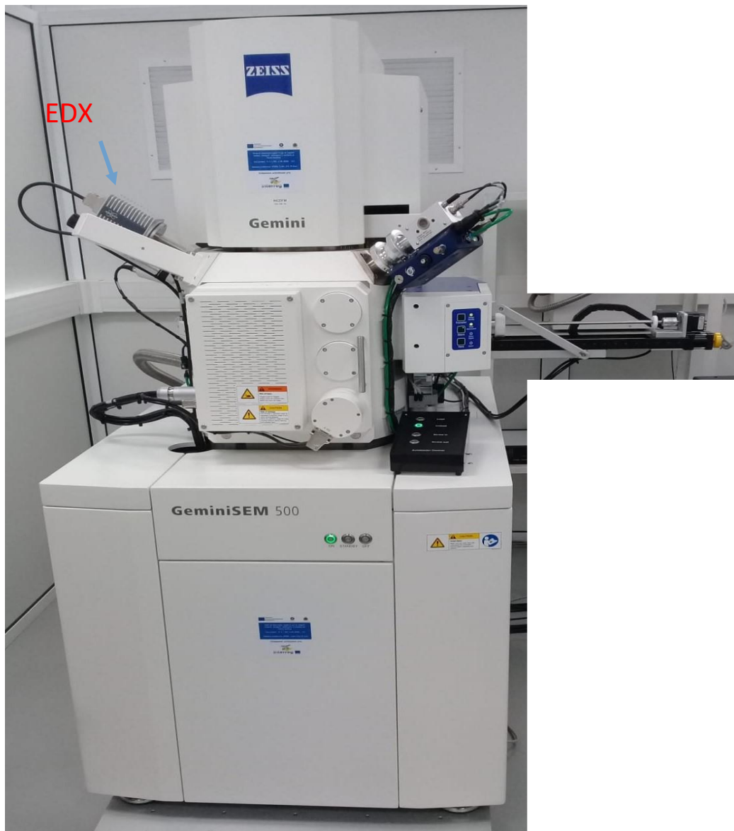
Figure 35: appareil d'analyse MEB couplé avec l'instrument d'analyse EDX
