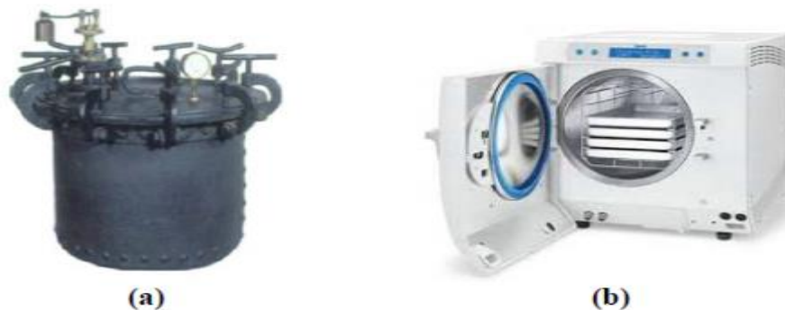
Figure II.5. Photos de l'autoclave de Chamberland (a) et d'un autoclave moderne (b)
