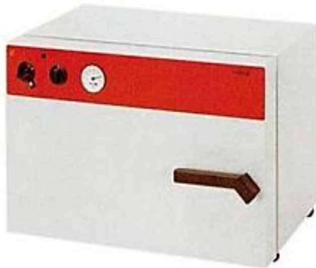
Figure II.4. Photographie d'une étuve sèche de Poupinel pour la stérilisation des instruments [43].
