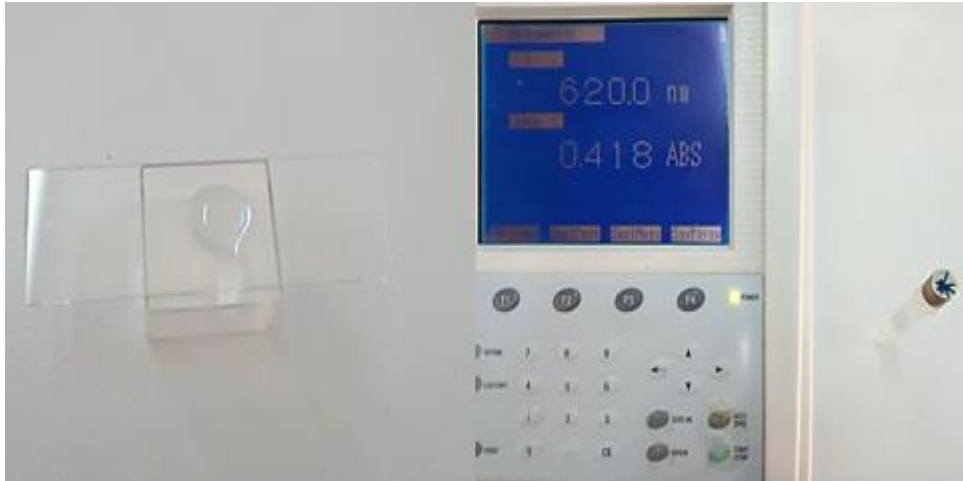
Figure IV .13. Photographie d'une goutte liquide E. coli et sa densité optique mesuré par le spectromètre.
