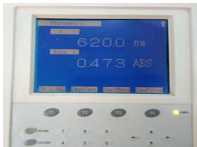
Figure V.5. Photographie de la densité optique mesurée par le spectromètre.
