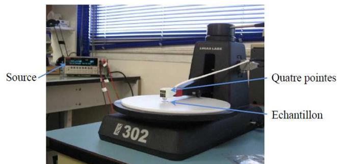
**Figure II.6 :** Montage utilisé pour les mesures de conductivité continue par la méthode des quatre pointes.
