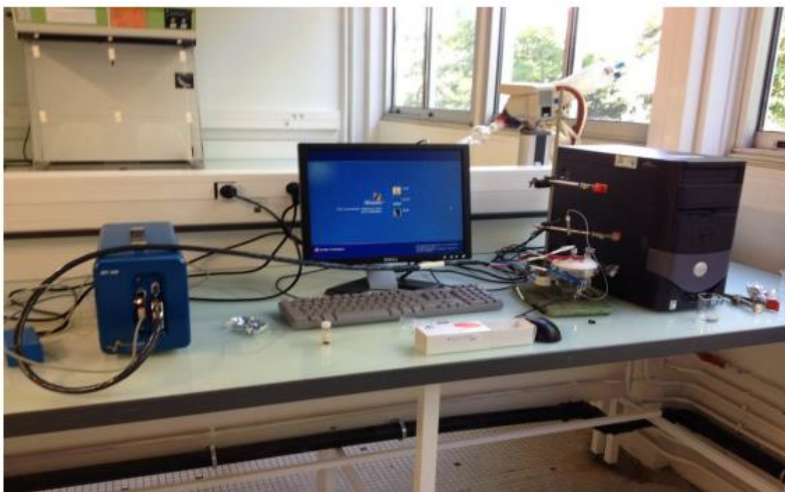
Figure II.4 : Montage utilisé lors des mesures de voltampérométrie cyclique.
