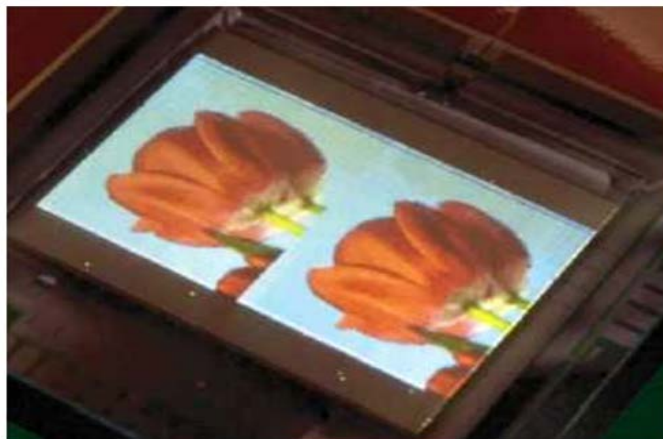
Figure I.22: Ecran polychrome tout polymère à base de OLED réalisé par Philips Electronics [41].
