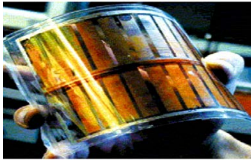
Figure I.21: Cellules photovoltaïques souples réalisées par Sariciftci et al. [40].
