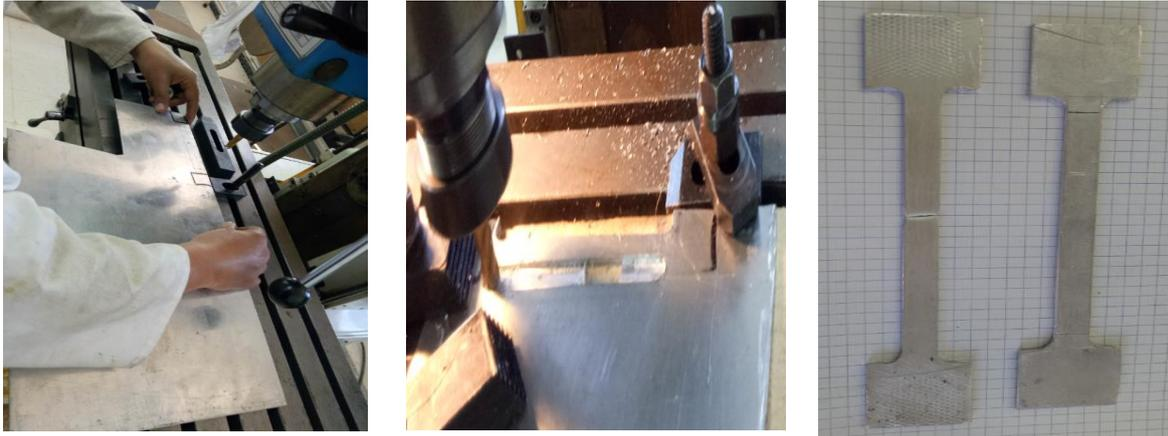
Figure III.6: Préparation d'une éprouvette sur la fraiseuse
