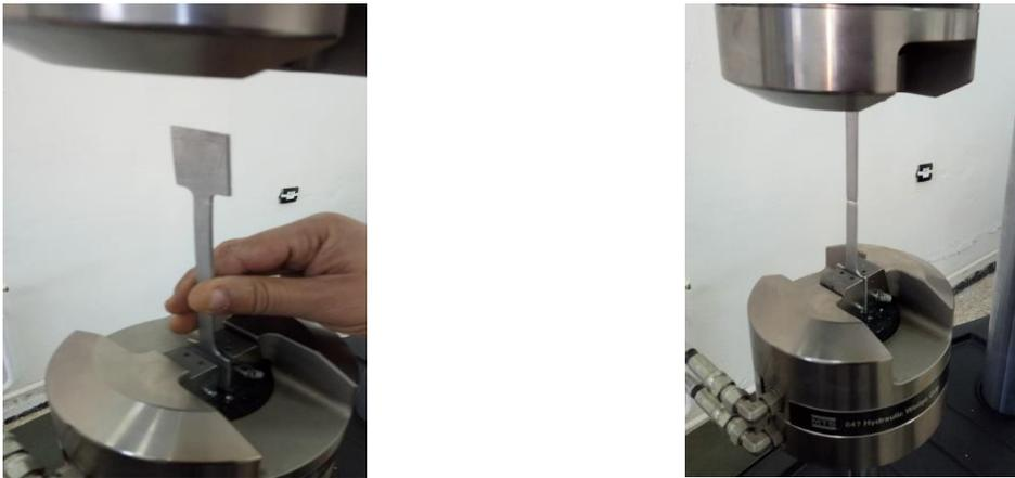
Figure III.9: Essai de traction sur éprouvette fixée verticalement et centrée entre les mors
