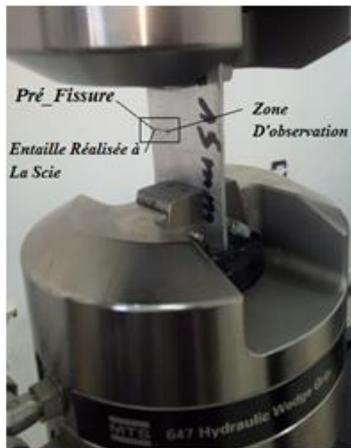
b) Eprouvette avant l'essai
