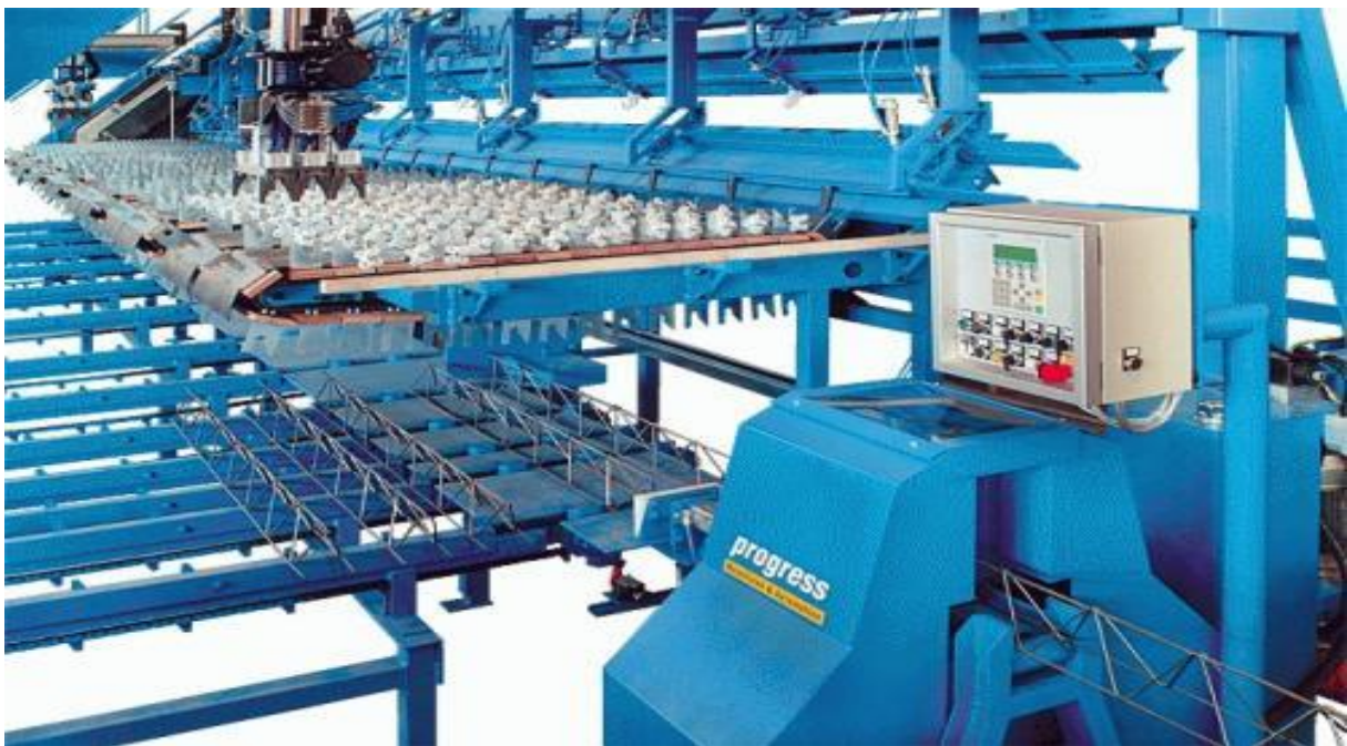
Figure 2.16 Les Machine pour préparation d'armature
