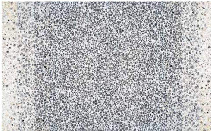
**Figure I.7:** Structure d'une paroi à gradient de propriétés, source: ILEKI
