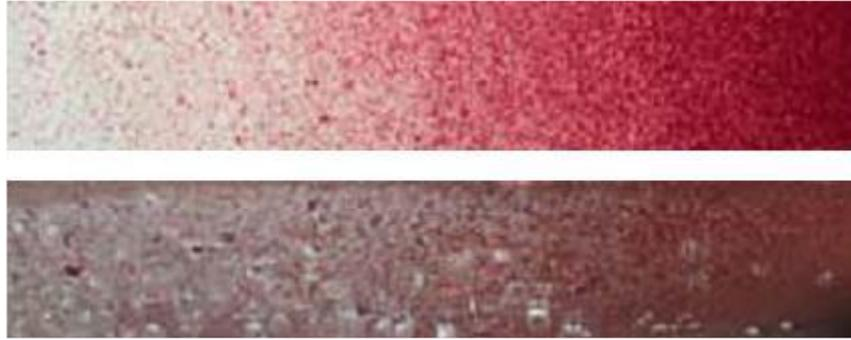
**Figure I.8:** En haut: texture en fibre de verre avec des éléments de silicium à perméabilité graduée, En bas: essai de l'étanchéité à l'eau, source: ILEK
