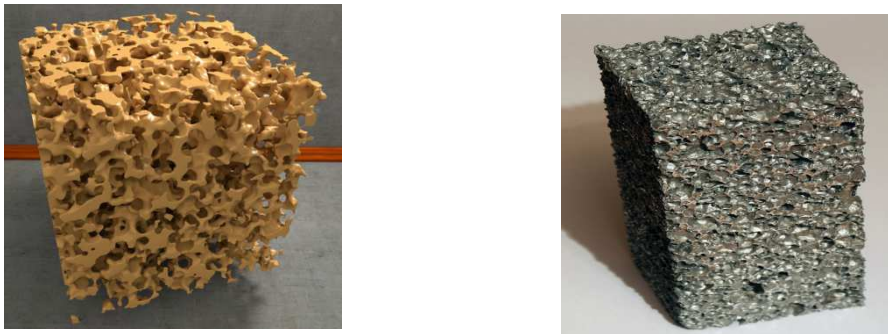
Figure II.10 : Simulation de deux structures : os spongieux et mousse de titane. [25]
