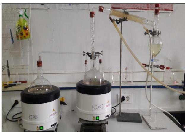
Figure n°29 : Extraction des huiles essentielles par l'entraînement à la vapeur ( ex situ ) (Blanchaud-Desce et al., 1987)
