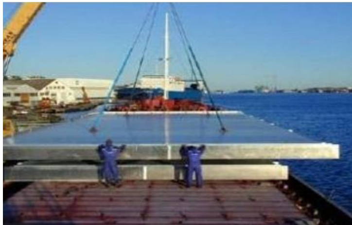
Figure II. 50 : Panneaux préfabriqués (Hydro Marine Aluminium) destiné au pont du bateau de croisière "The World" [34].
