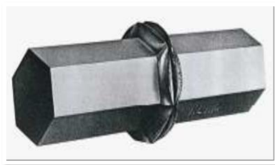
Figure II.22 principe de soudage par friction orbital [25]
