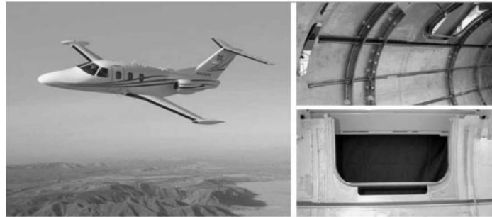
Figure II.48 : Assemblage de l'avion Eclipse 500 avec le procédé de soudage FSW [31].
