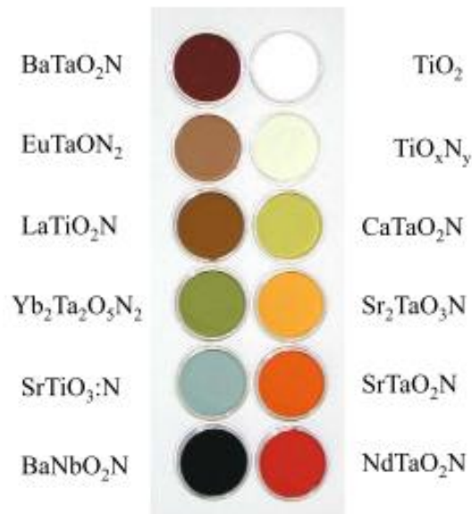
Figure 1.4. Les couleurs des composés oxydes et des oxynitrures.
