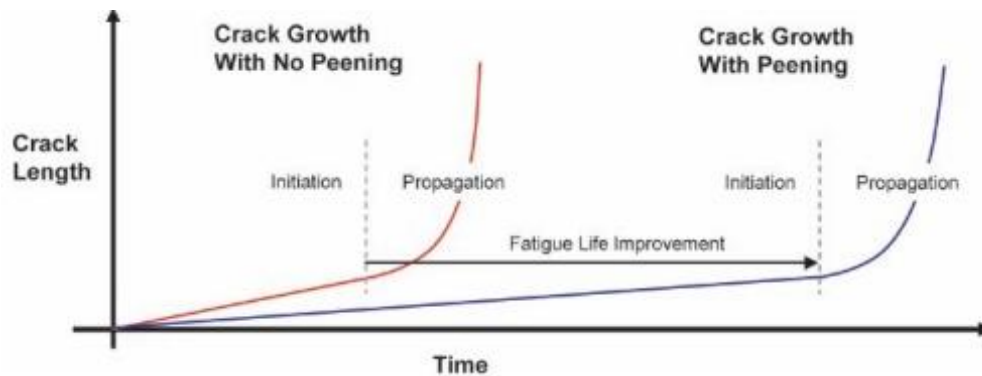
Fig II.23 Comparaison entre plaque réparée et plaque non réparée.
