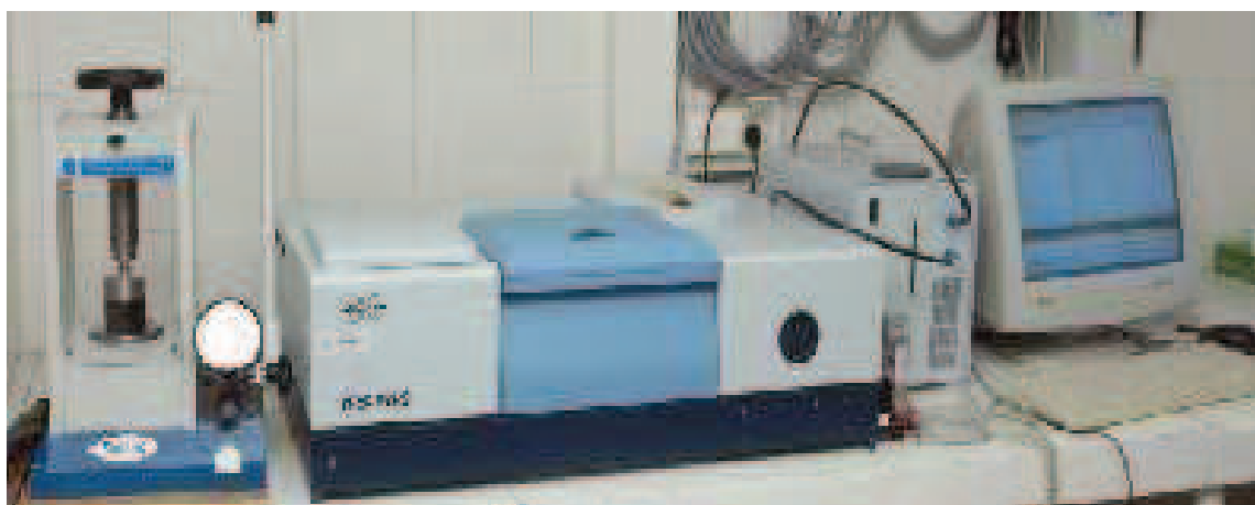
Fig 5 : Spectromètre infrarouge à transformée de Fourier Bruker Alpha (Résolution allant jusqu'à 1 \text{ cm}^{-1} ) - Université d'Alicante.
