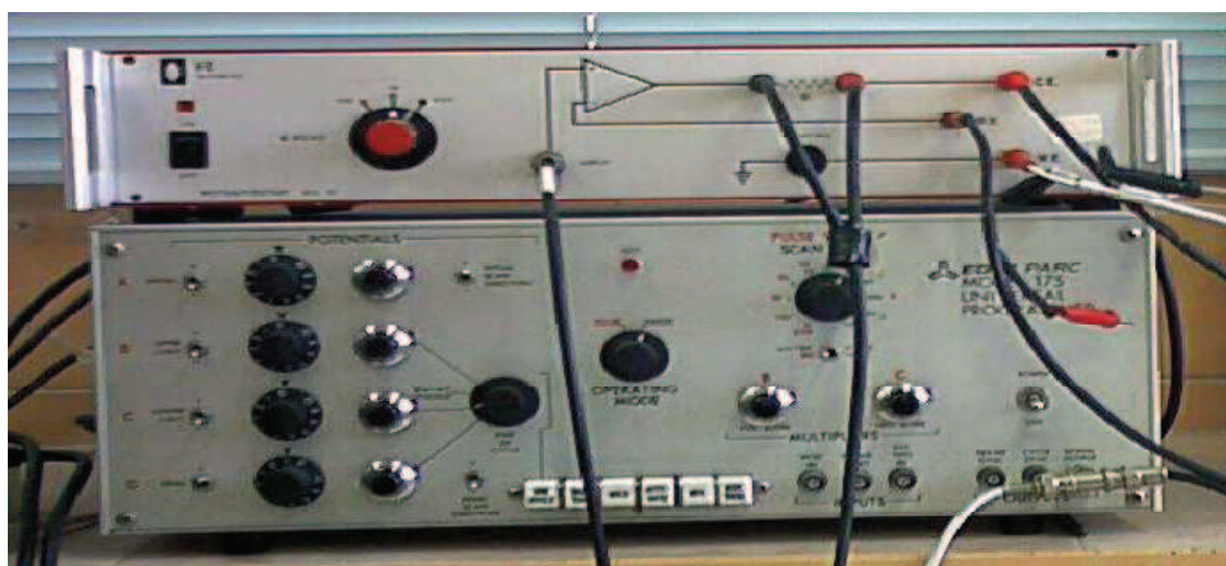
Fig 9 : potentiostat HQ Instruments model 101, relié à un enregistreur XY Philips model PM 8133.
