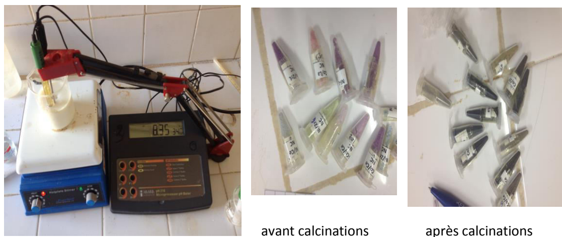
Figure II.5. Montage de synthèse, photo des échantillons avant et après calcinations
