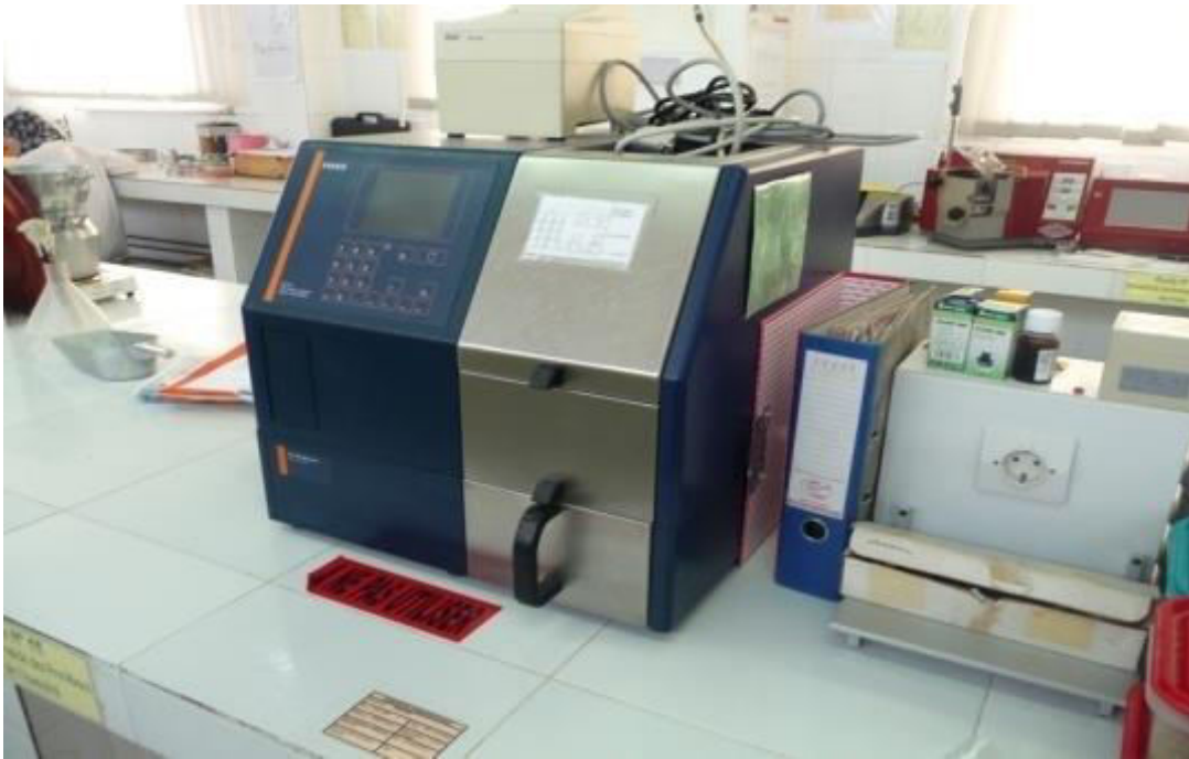
Figure 30: Infracotec -appareil utilisé pour la mesure d'humidité
