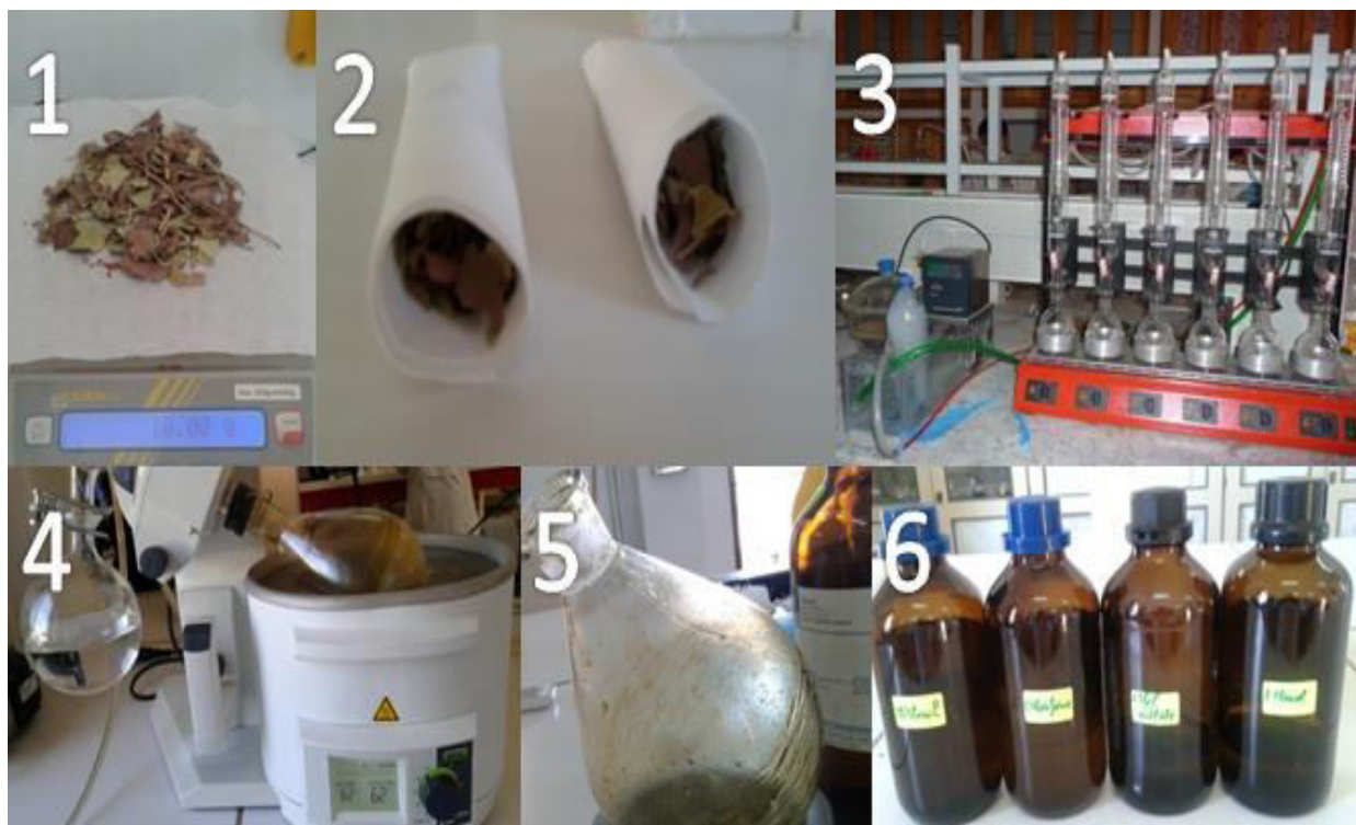
Figure 42: Étapes d'extractions ; (1) plante (2) plante dans les cartouches d'extraction, (3) soxhlet multipostes (4) concentration par rotavapeur (5) extrait concentré (6) solvants d'extraction.
